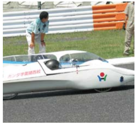
※Ene-1 GPとは、充電式単三電池40本を使用し鈴鹿サーキットを2周走行できる車両を製作しエネルギーマネージメントを競う研鑽の場である
