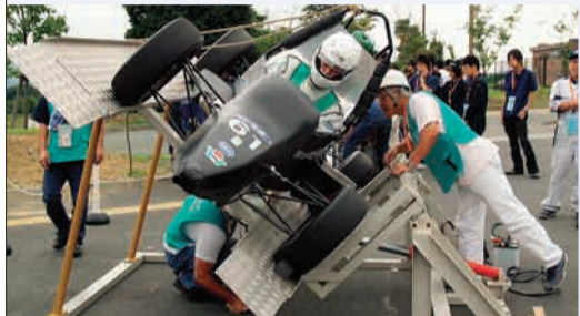
車検 チルト(ガソリン漏れ検査)
