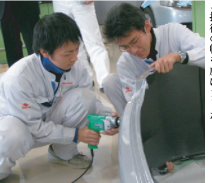
バンパー穴開け作業
